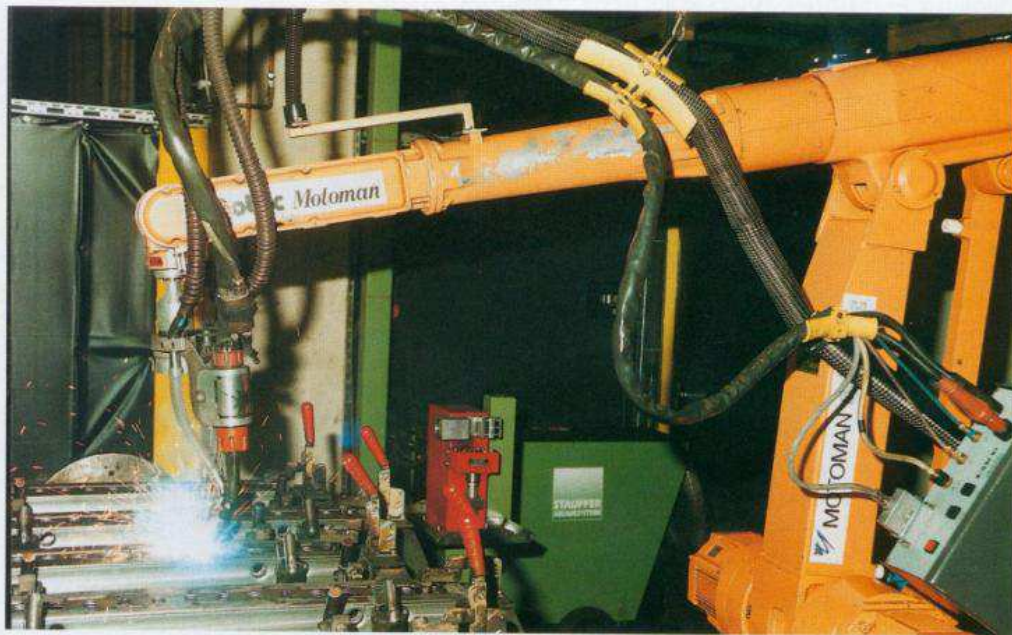
Die kleinbauende Absaugung am Brenner schränkt die Bewegungsfreiheit der Schweißdüse nicht ein. Bild: Peri
